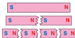
شکل ۳- هر یک از آهن رباهای شکسته نیز دارای دو قطب S و N هستند.
