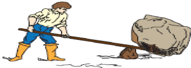
شکل ۳ - مرد با وارده کردن نیروی کوچکی بر دسته اهرم می تواند جسم سنگینی را بلند کند.
